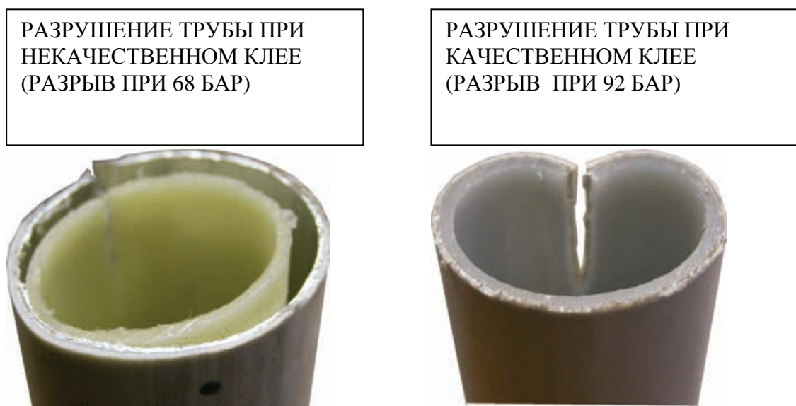
Рис.2.3.4.р.1 Вид среза МПТ после разрывных испытаний
