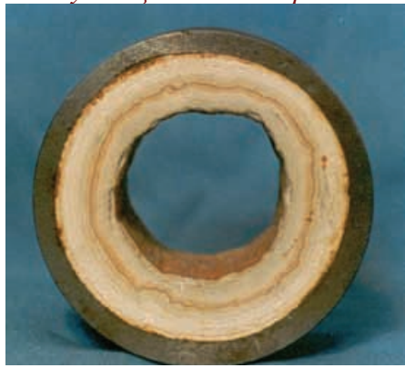
Рис.2.5.3.п.1 Срез стальной трубы после 8 лет эксплуатации на водопроводе
