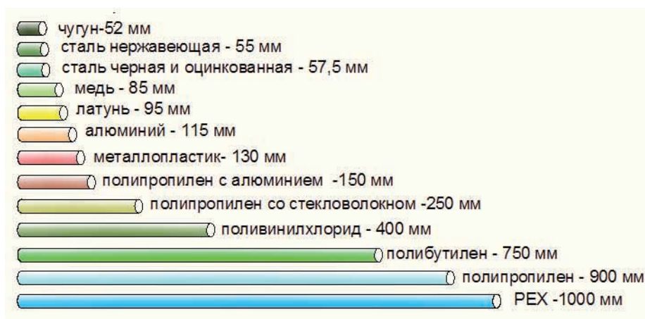
Рис. 2.5.1.р.1 Диаграмма удлинения 100м трубы при повышении температуры на 50^\circ\text{C}
